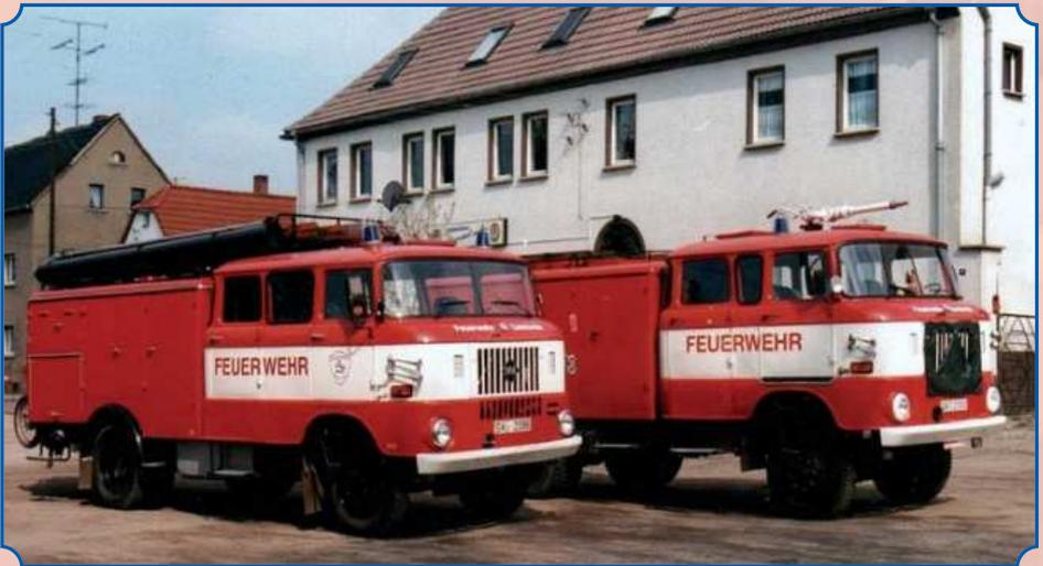
**Abb. 6:** Nach der Wende 1989 wurden durch Privatinitiative der Feuerwehrkameraden verschiedene Löschfahrzeuge beschafft. Durchgesetzt haben sich bis 2009 nur das Löschgruppenfahrzeug 1600 (LF 16) auf W 50 und das Tanklöschfahrzeug 1600 (TLF 16) auf W 50.
