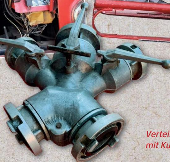
Verteiler 2B-C-B-C mit Kugelabsperrorganen
