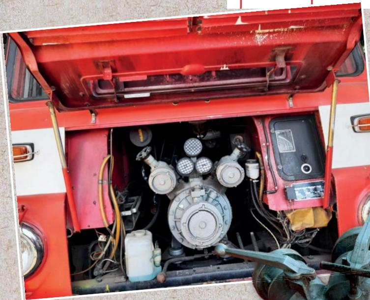
LF 8 Löschfahrzeug mit eingebauter Feuerlösch-Kreiselpumpe 8/8 (Vorbaupumpe) auf Robur LO
