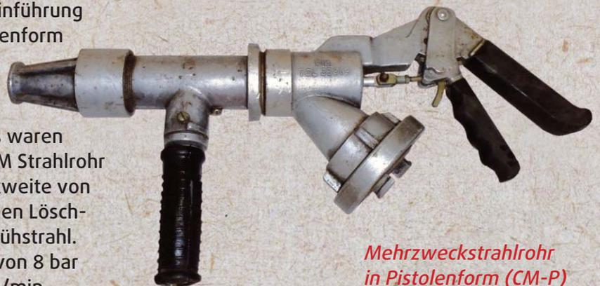
*Mehrzweckstrahlrohr in Pistolenform (CM-P)*
